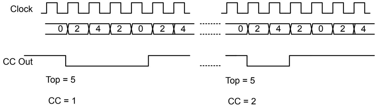
Figure 20.34. TIMER/WTIMER CC out in 2x mode
