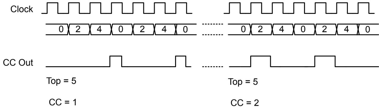
**Figure 20.25. TIMER/WTIMER CC out in 2x mode**
