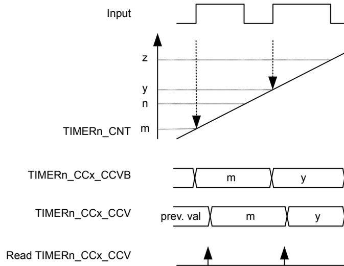
**Figure 20.12. TIMER/WTIMER Input Capture**
